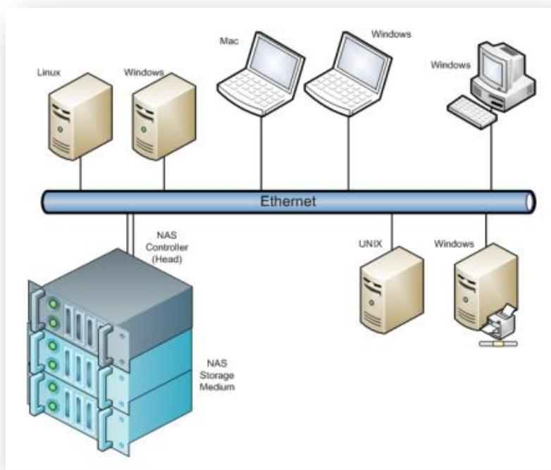
انباره (Storage) ذخیره سازی متصل به شبکه (Nas) دستگاهی است که به صورت اشتراکی در شبکه مورد استفاده قرار می‌گیرد. این دستگاه، با استفاده از NFS (سیستم فایلی شبکه ای مختص یونیکسی)، CIFS (سیستم فایلی شبکه ای مختص محیط های ویندوزی)، HTTP و سایر پروتکل ها با اجزای شبکه ارتباط برقرار می‌کند. وجود NAS در یک شبکه برای کاربران آن شبکه افزایش کارایی و استقلال از سکو را به ارمغان می‌آورد، گویی که این انباره مستقیماً به کامپیوتر خودشان متصل است.
