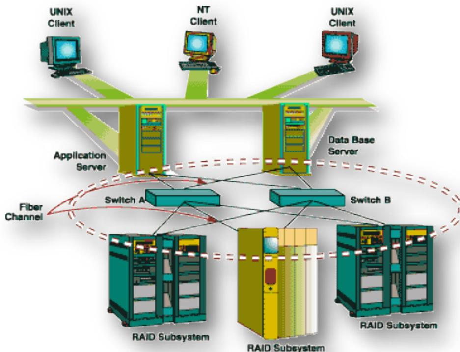
ها معمولاً از توپولوژی Fiber Channel Fabric استفاده می کنند ، این ساختار مخصوص شبکه Storage SAN شده است. این ساختار دارای سرعت و اطمینان بالاتری نسبت به پروتوكل های سطح بالاتر استفاده شده در NAS می باشد. همانند شبکه های مبتنی بر LAN ، در شبکه SAN نیز از سوئیچهای خاص استفاده می شود. نکته قابل توجه این است که در اینجا به ساختار شبکه ، FC اطلاق می شود، در حالی که فیبر فقط یک مدیا است . در بعضی از ارتباطات داخلی های ویژه SAN، از کابل مسی استفاده می شود
